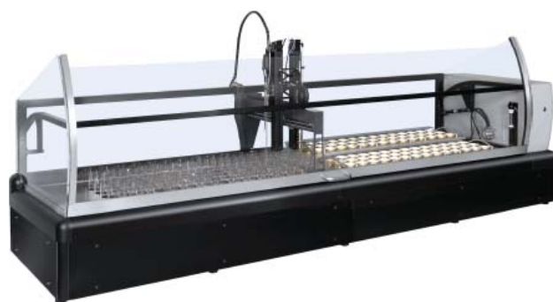
SP2000 анализатор гранулометрического состава почвы
